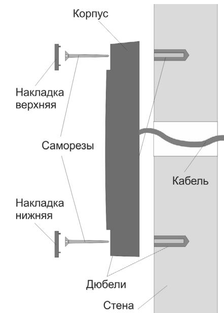
Рисунок 2. Крепление считывателя
