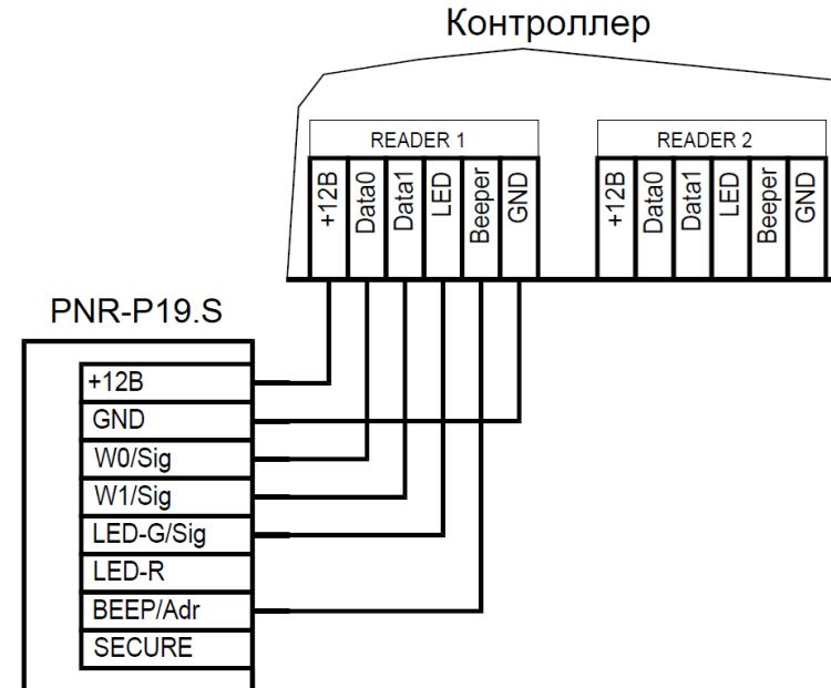
Рисунок 4. Подключение считывателя по интерфейсу Wiegand
