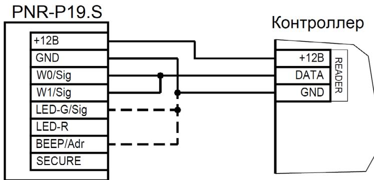
Рисунок 3. Подключение считывателя по интерфейсу Touch Memory
