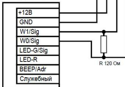
Рисунок 5. Подключение считывателя по интерфейсу OSDP
