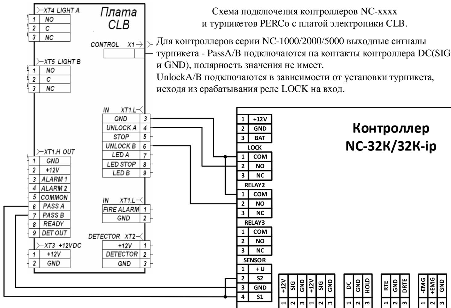
Для контроллеров серии NC-1000/2000/5000 выходные сигналы турникета - PassA/B подключаются на контакты контроллера DC(SIG и GND), полярность значения не имеет. UnlockA/B подключаются в зависимости от установки турникета, исходя из срабатывания реле LOCK на вход.
